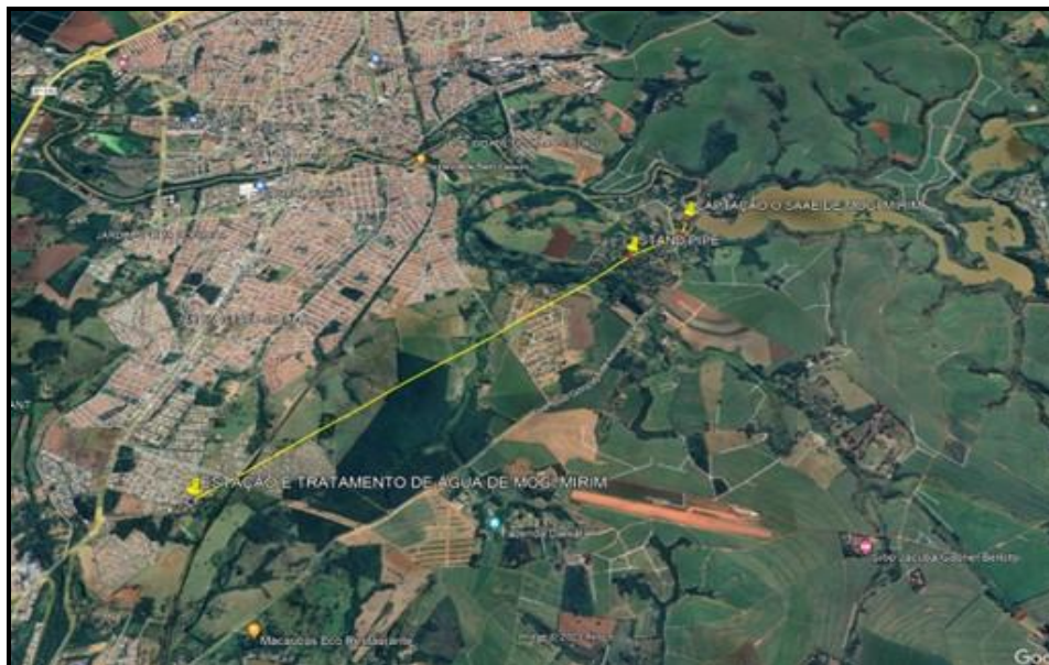
Figura 24 - Caminhamento das Adutoras de Água Bruta entre a Captação e a ETA 1
