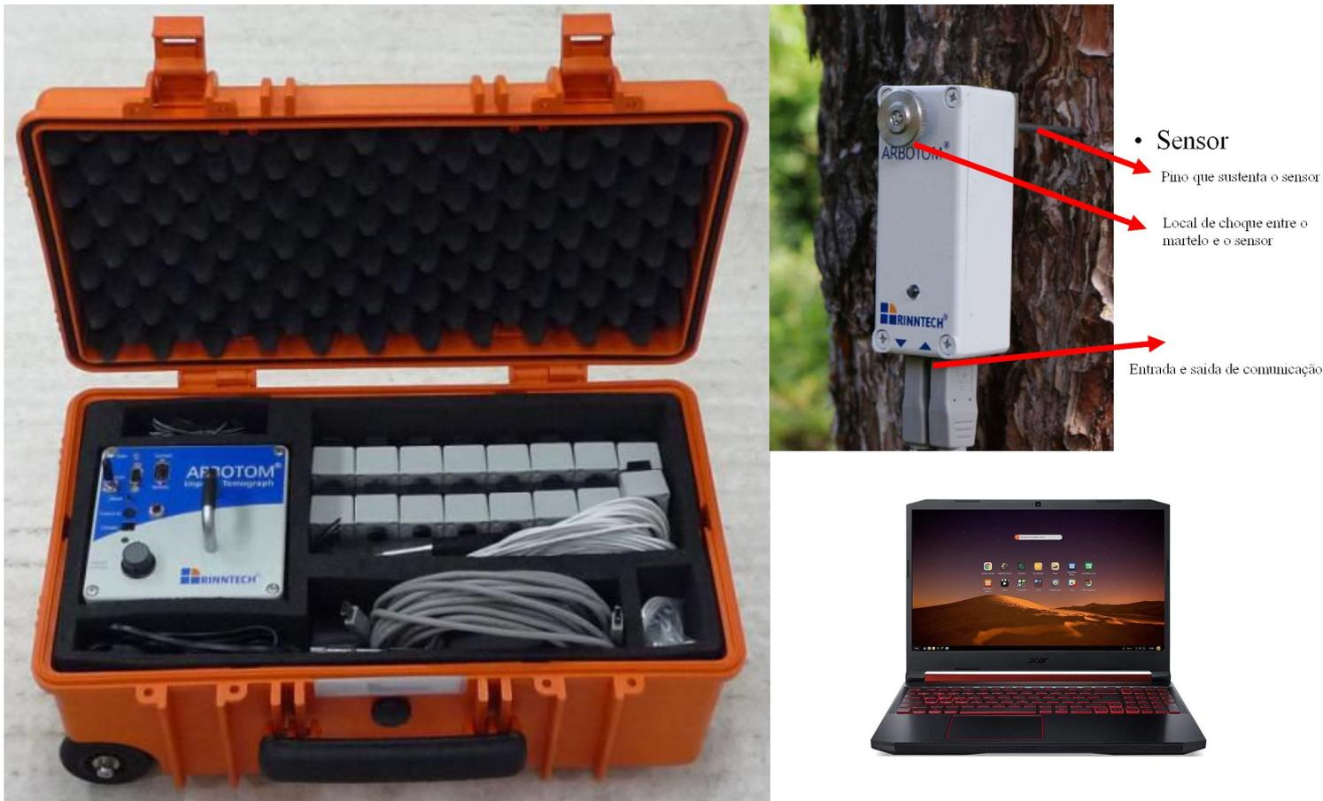
Figura 1. Maleta contendo todos os componentes do Tomógrafo de impulso e ao lado um detalhe de um sensor já montado em uma árvore contendo indicações sobre os componentes usados para produção de imagens internas de uma secção do caule das árvores.
