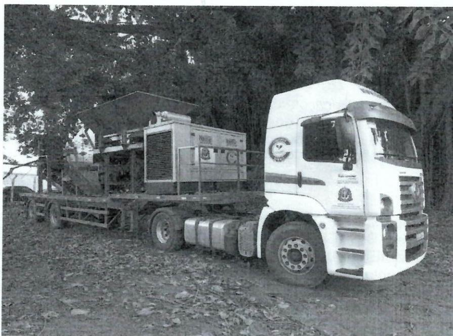
**Imagem 21** - Vista lateral do Unidade Móvel de triagem de RCC. Elaborado pela FIA (2023).
