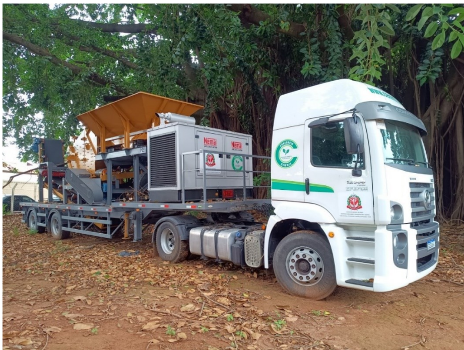
Imagem 20 - Unidade Móvel de triagem de RCC. Elaborado pela FIA (2023).
