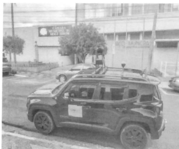
Figura 3 - Veículo do Mapeamento Móvel Terrestre 360°
