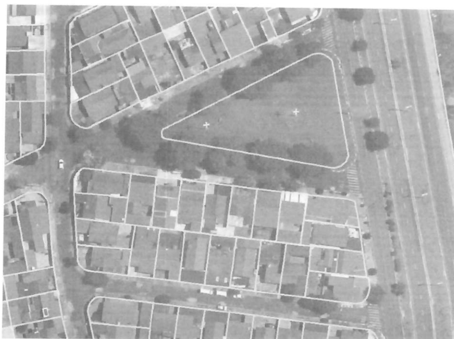
Figura 16 - Exemplo de Restituição Digital sobreposta com Ortofoto
